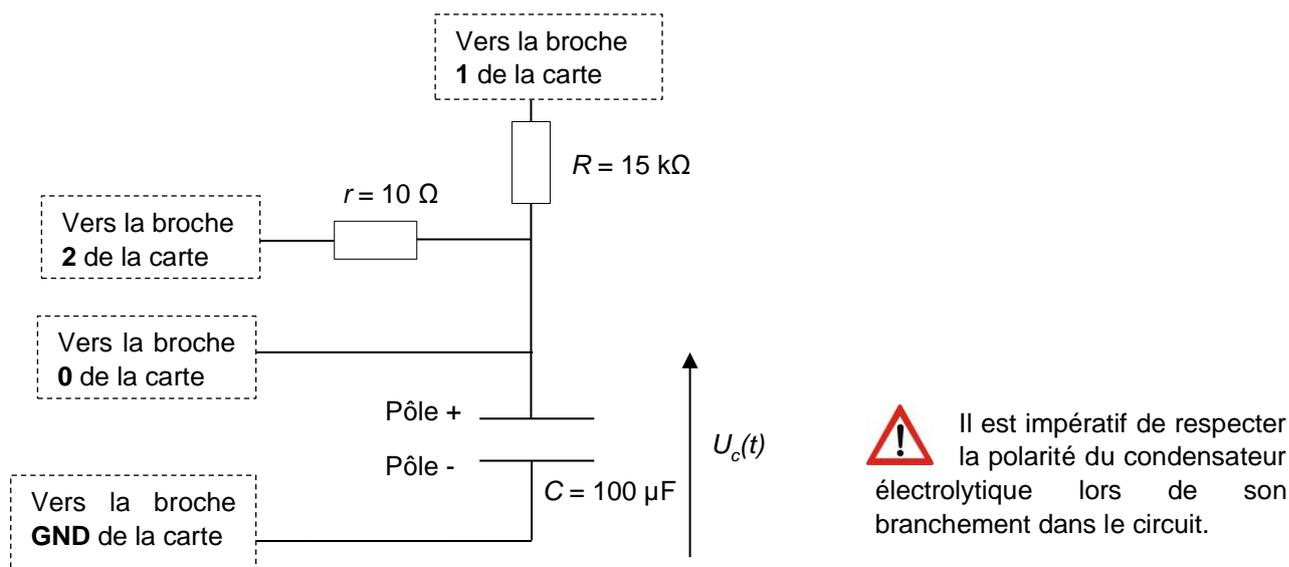
$r$  : résistance du conducteur ohmique du circuit de charge.
