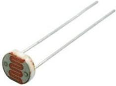
Une photorésistance est un capteur dont la valeur de la résistance varie en fonction de l'éclairement. Plus l'intensité lumineuse est élevée, plus la valeur de la résistance est faible. Les photorésistances CdS sont sensibles aux radiations lumineuses du visible avec un pic de sensibilité à environ 520 nm (vert).
