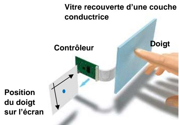
Lors du contact d'un doigt (conducteur) sur la vitre, la surface se décharge localement, induisant une diminution de tension qui permet au contrôleur de déterminer la position du contact. Nous considérons, pour simplifier, que le contact du doigt sur la vitre modifie la charge d'une seule surface élémentaire.
