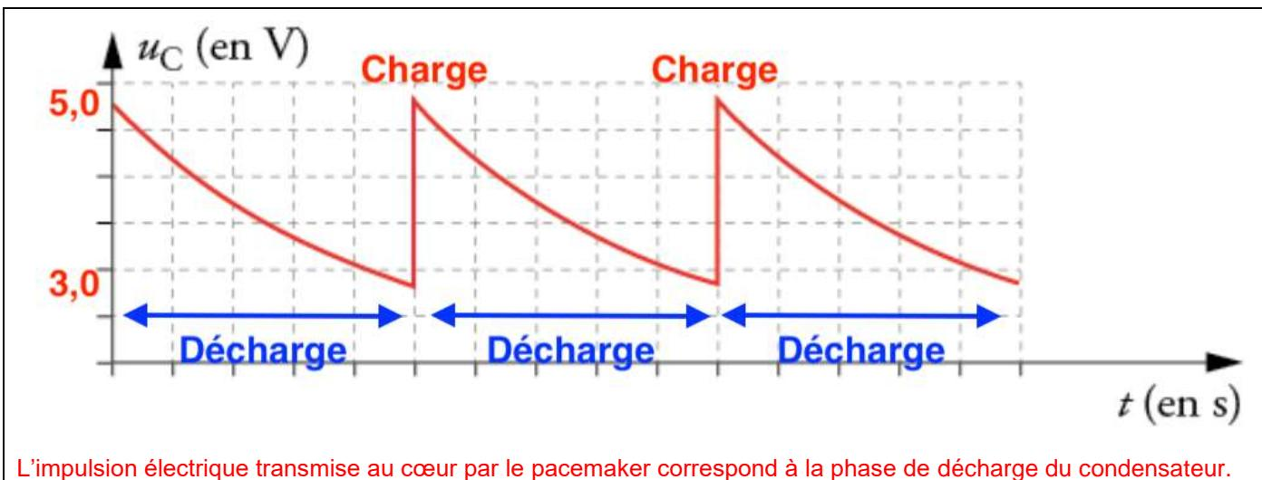
L'impulsion électrique transmise au cœur par le *pacemaker* correspond à la phase de décharge du condensateur.
