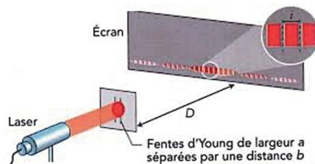
Deux fentes de Young séparées d'une distance  $b$  sont éclairées par un laser. Chaque fente diffracte la lumière. Les deux faisceaux de lumière diffractés par les doubles-fentes interfèrent et forment une figure d'interférences dans une figure de diffraction.
