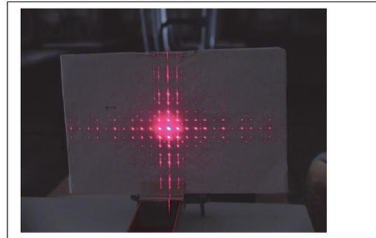
Les fils de petite dimension constituant le tamis diffractent la lumière du laser. La superposition de ces figures de diffraction donne la figure d'interférences représentée ci-dessus.
