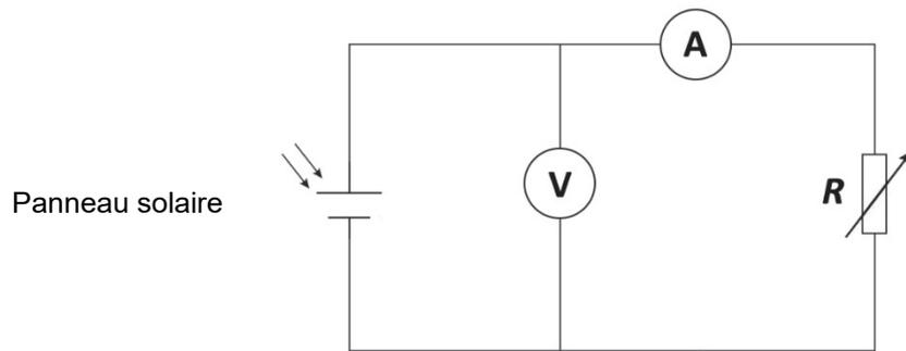
1.1. Proposer un protocole expérimental permettant, à l'aide du montage fourni et d'un logiciel tableur-grapheur, de tracer la puissance en fonction de la tension aux bornes du panneau solaire.
