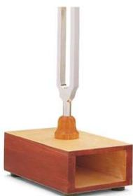
Un diapason est un objet constitué de deux branches métalliques soudées en forme de U et prolongées par une tige pouvant, dans certains cas, être fixée sur une caisse en bois. Lorsqu'on heurte l'une des deux branches d'un diapason, celui-ci se met à vibrer et produit un son dont la hauteur permet aux musiciens d'accorder leurs instruments.
