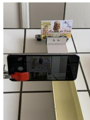
***Le but de cette épreuve est d'estimer la distance focale de la lentille modélisant l'objectif de l'appareil numérique.***
