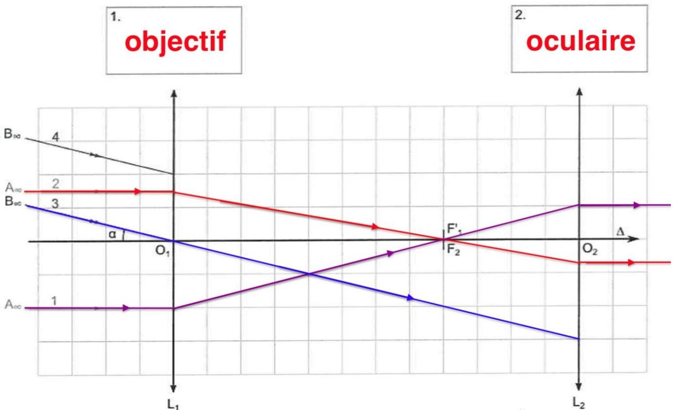
Position de  $B_1$  image intermédiaire de  $B_\infty$  : Comme l'objet  $A_\infty B_\infty$  est à l'infini, son image  $A_1 B_1$  est dans le plan focal image de l'objectif  $L_1$ .
