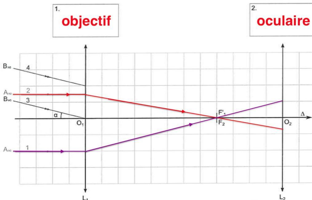
Les rayons issus de  $L_1$ , passent par le foyer  $F_2$ . Ils sont déviés en sortant de  $L_2$  parallèlement à l'axe optique.
