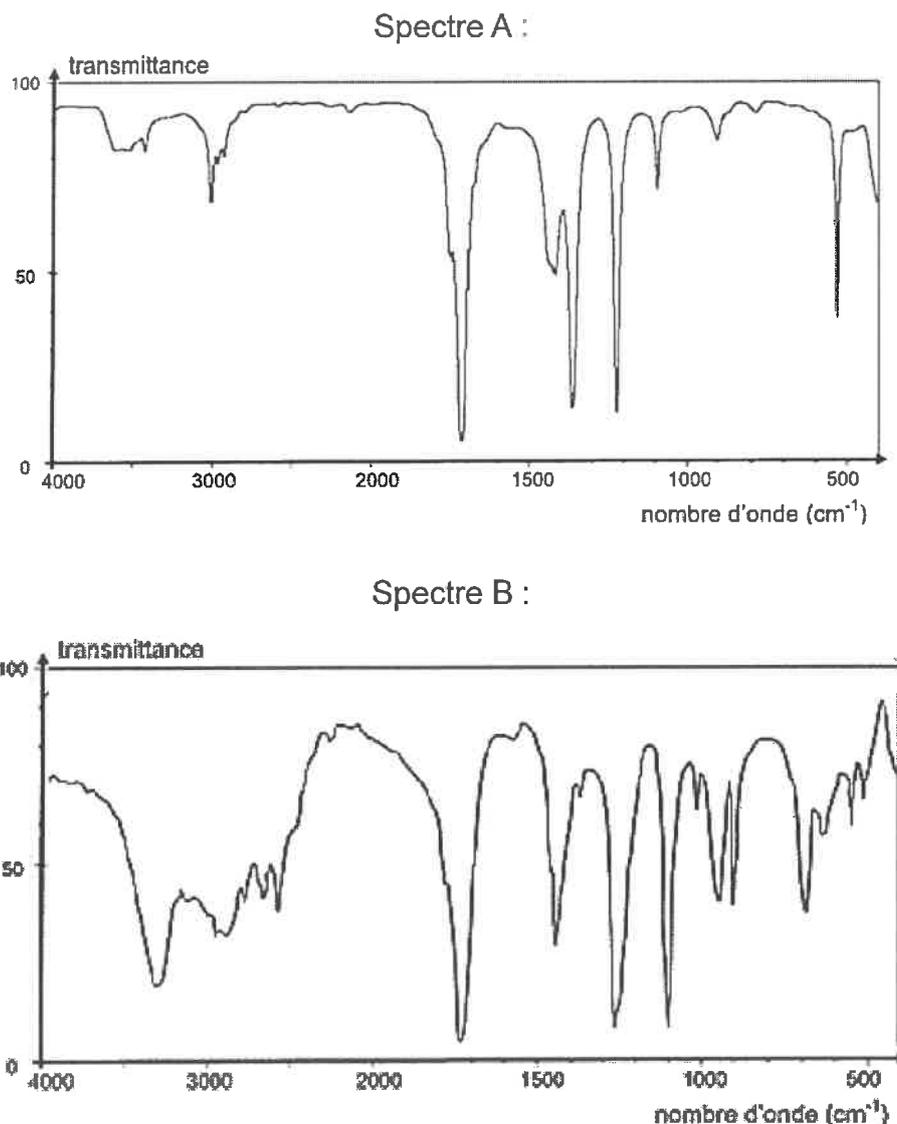
Figure 1. Spectres infrarouge de deux espèces chimiques.
