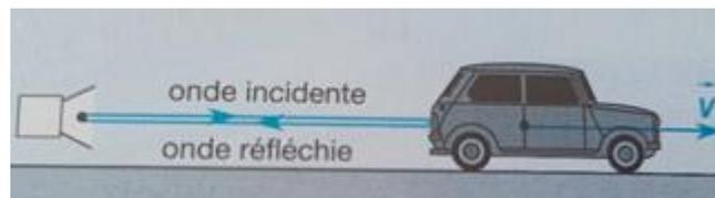
Figure 4. Schéma de principe de fonctionnement d'un radar
