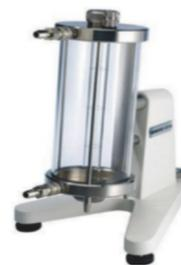
Viscosimètre à chute de bille KF40 Brookfields®
