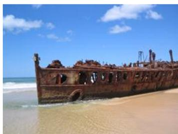
La corrosion est un phénomène bien connu des marins. Les bateaux dont la coque est en acier en sont victimes et doivent en être protégés. Une méthode de protection consiste à poser à la surface de la coque des blocs de métal appelées « anodes sacrificielles ».
