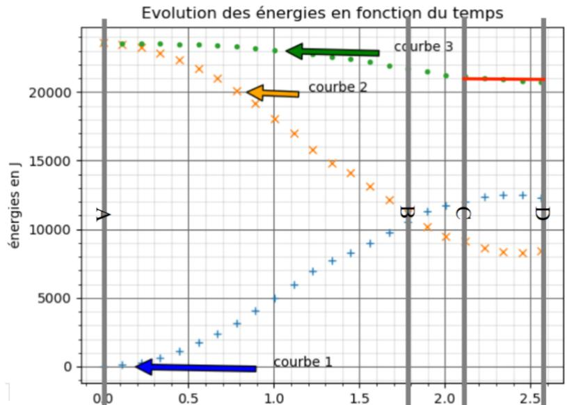
Remarque pour le saut entre la partie A et B (non demandée) : L'énergie mécanique (courbe 3) diminue entre les points A et B. Les forces de frottements ne sont donc pas négligeables. Dans notre cas, une chute libre sans frottements n'est pas justifiée.
