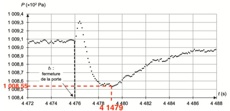
Figure 2. Évolution temporelle de la pression P de l'air intérieur du réfrigérateur S, avant et après fermeture de sa porte
