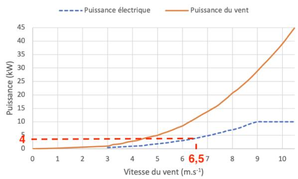
Pour une vitesse du vent inférieure à 3 m.s⁻¹, l'éolienne ne produit pas d'électricité.
